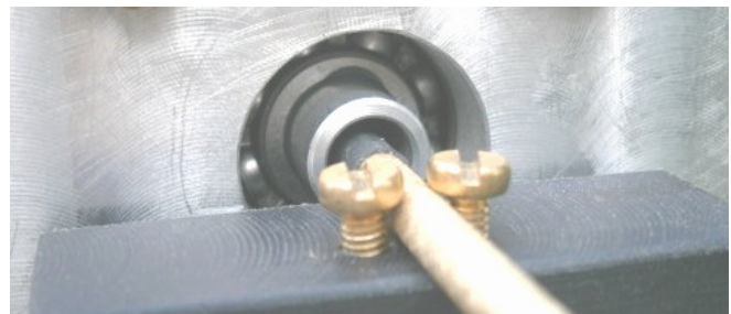
Obrázek 7. Detail vodičské cesty s výstupem dutou hřídelí.
